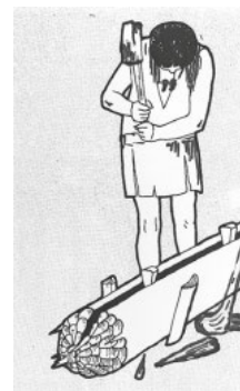
Mann beim spalten eines Baumstammes mit Hilfe von Spaltkeilen bei der Bretterherstellung
